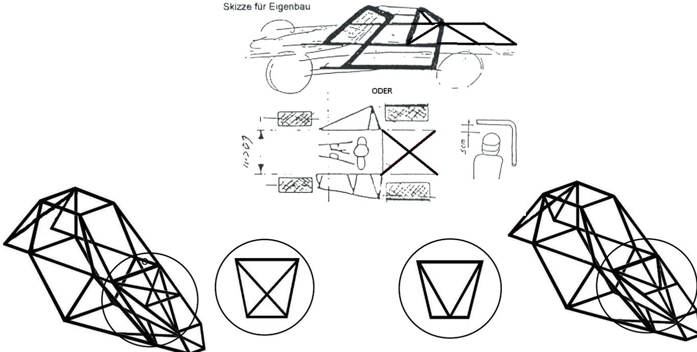
Verstärkung (Fußraum) unten & oben, X oder V Verstärkung mind. 20x2mm, Querverbindung Lenkradhöhe mind. 30x2mm
